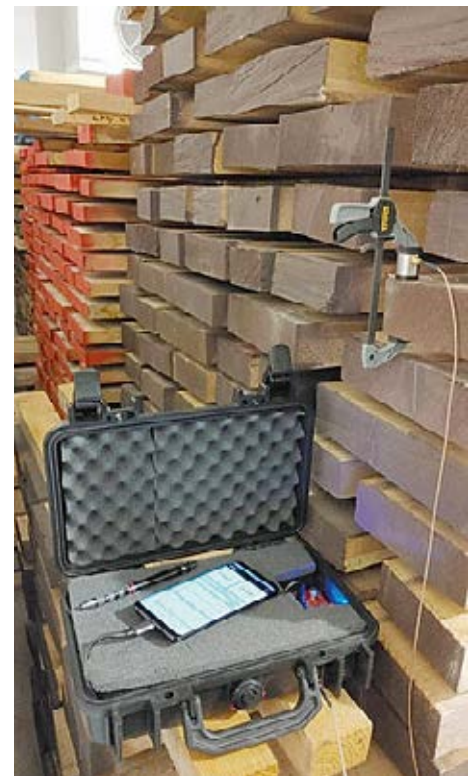
Importiertes Laubholz kann vor der Auslieferung akustisch auf aktiven Insektenbefall überprüft werden. oben: angeklebter Sensor; unten: mobiler Messkoffer mit Mobiltelefon und Akku.
